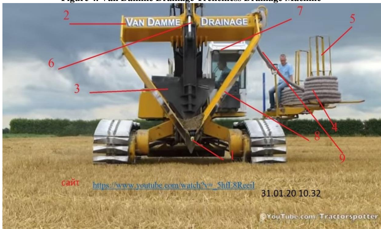
Рисунок 4. Машина для устройства бестраншейного дренажа Van Damme Drainage Figure 4. Van Damme Drainage Trenchless Drainage Machine
