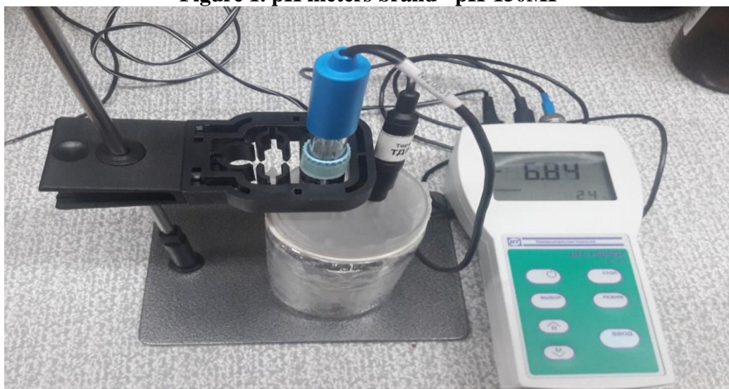
Рисунок 1. рН-метрам марки «рН-150МИ Figure 1. pH meters brand "pH-150MI
