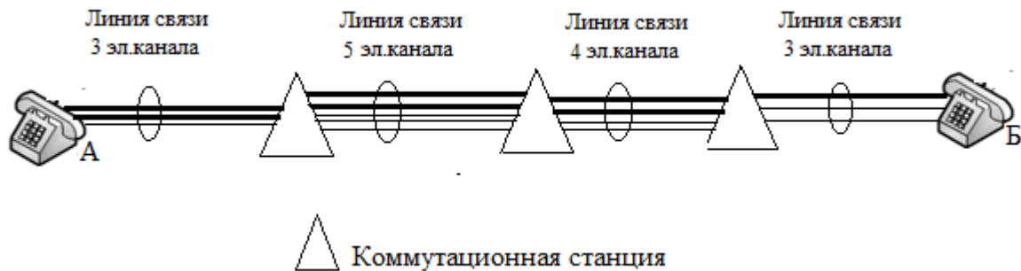
Рис. 1 Сеть с коммутацией каналов Figure 1 Circuit Switched Network
