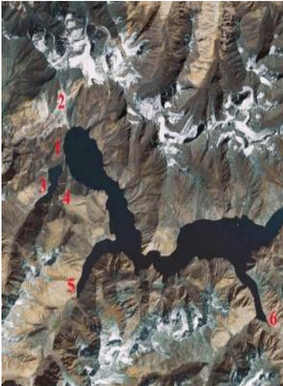
Рис. 2. Сарезское озеро, вид с Космоса: 1 - Усойский завал, 2 - Место срыва оползня, 3 - озеро, Шадау, 4 - перевал Марджанай, (1А, 3850), 5 - Ирхтский залив, 6 - залив Рамаиф.
