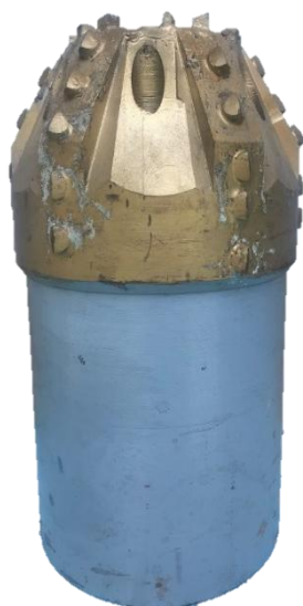
Рис. 2. Шестилопастная бурильная головка типа «6 ЛБК»-«МСЗ» Fig. 2. Six-blade drilling head of the type "6 LBK" - "MSZ"
