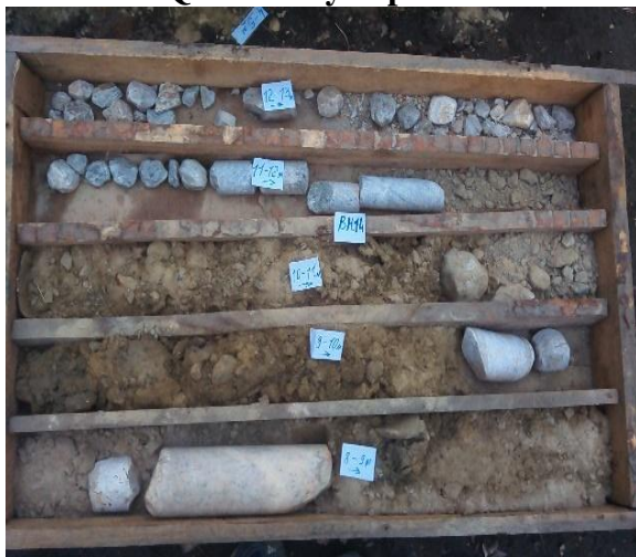
Рис.2. Отбор керна из рыхлых четвертичных отложений Fig.2. Core sampling from loose Quaternary deposits
