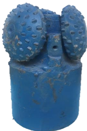
Рис. 1. Трехшарошечная бурильная головка типа «6 ВК»-«СЗ» Fig. 1. Three-cone drilling head type "6 VK" - "SZ"
