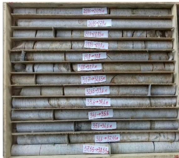
Рис.3. Отбор керна из скального массива Fig.3. Core sampling from a rock mass
