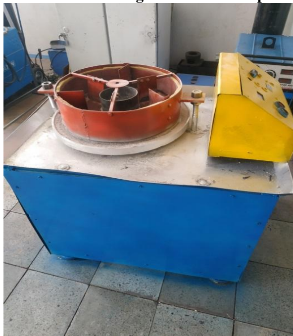
Рисунок 2. Станок для формообразования шариков из самоцветных камней Figure 2. Machine for forming balls from semi-precious stones
