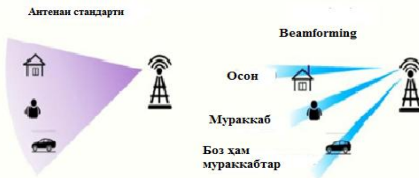
Расми 3. Ташаккули нурҳои Beamforming Figure 3. Beamforming
