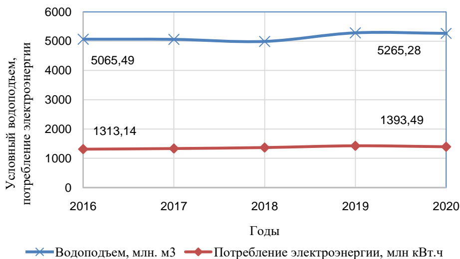
Рисунок 1. Условный водоподъем насосными станциями и соответствующее потребление электроэнергии насосными станциями в Таджикистане [1] Figure 1: Conditional water lift by pumping stations and corresponding electricity consumption by pumping stations in Tajikistan
