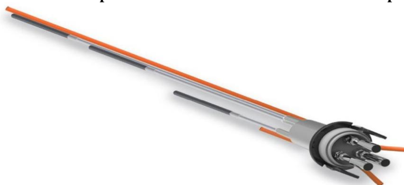
Рисунок 8. Схематическое изображение экстензометра с многоточечными стержнями Figure 8. Schematic representation of an extensometer with multipoint rods
