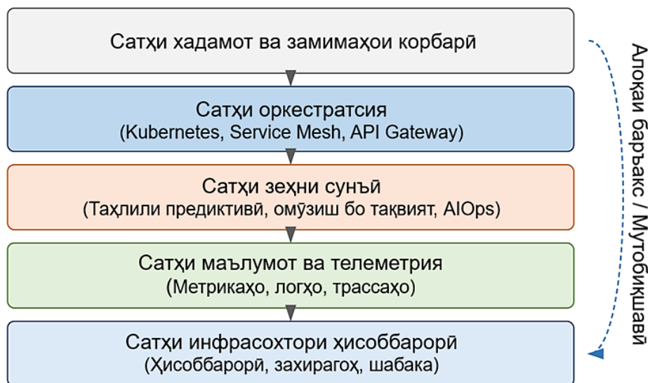
Расми 6. Архитектураи экосистемаи рақамии зехнӣ Figure 6. Architecture of the intelligent digital ecosystem
